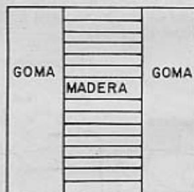
Fig. 1 Plataforma de levantamiento de pesas hecho de madera y goma
