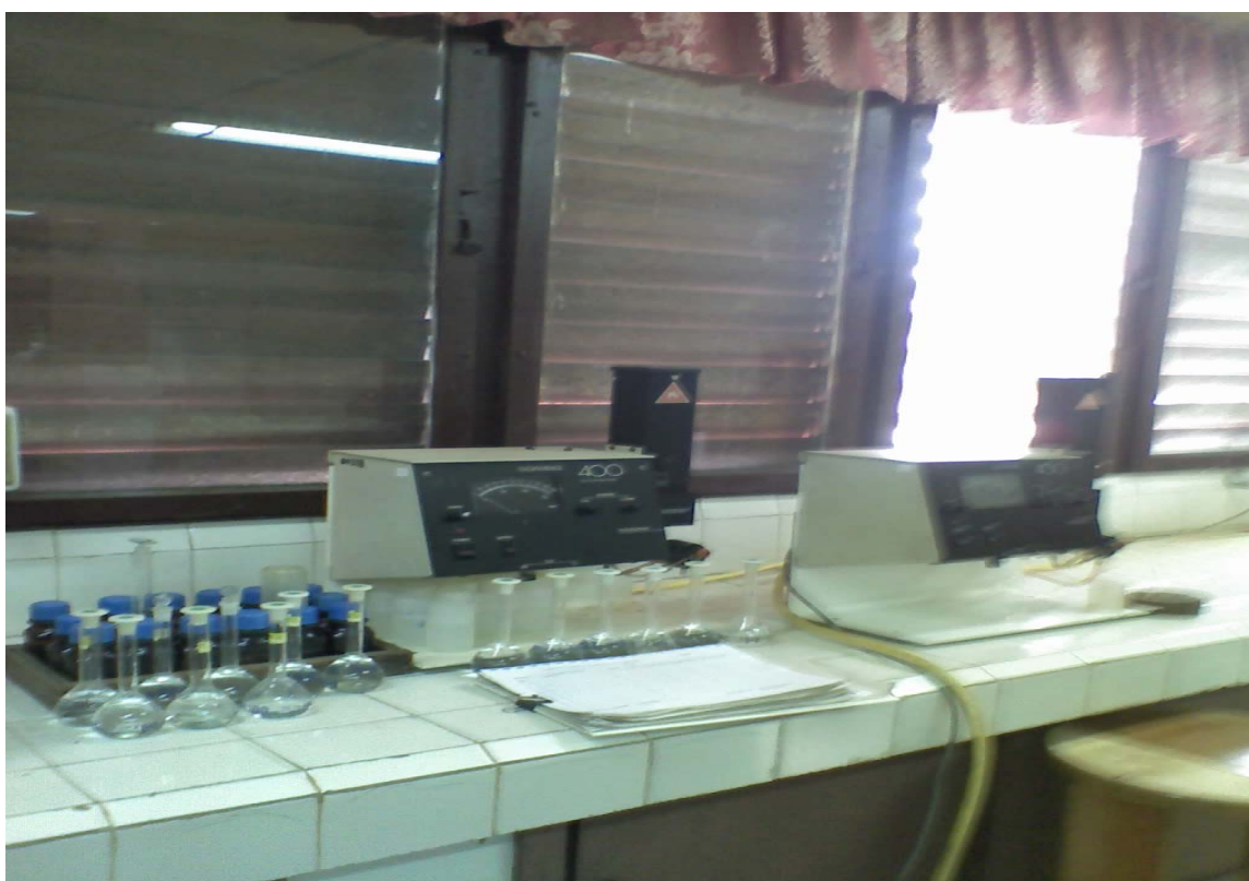
Figura 10.3: Fotómetros de llama en una mesa de trabajo del laboratorio (Arzola, 2009).
