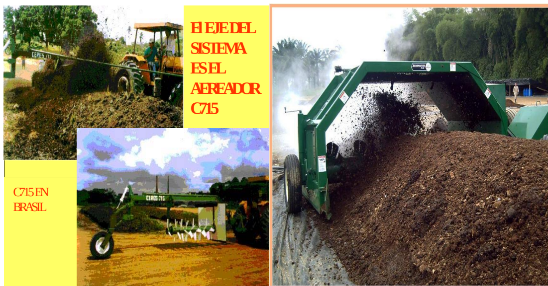
Figura 9.4. Aereador de compost C715 creado en el INICA,Cuba a la izquierda (Velarde, 2000) y composteador brasileño foto a la derecha.
