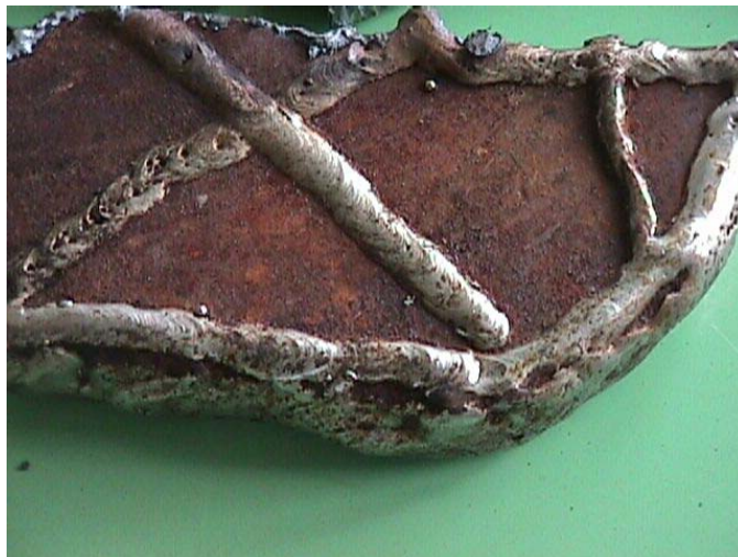
Fig. 4 Vista ampliada del relleno del filo.
