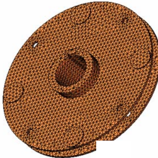
Fig. 8: Mallado utilizado para realizar los cálculos.
