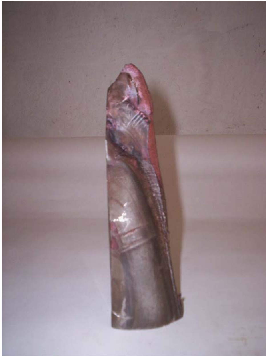
Fig. 21 Vista ampliada de la Grieta de Fatiga y la zona de cambio de orientación de la Grieta cuando Z > 130 \text{ mm} .
