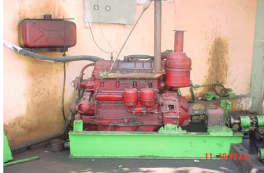
Fig. 2 Motor Diesel A-41, reductor de simple paso y transmisión por cadena
