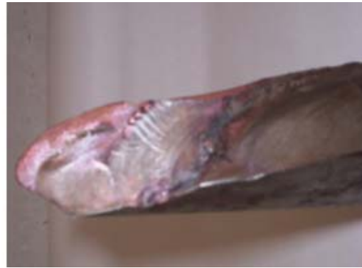
Fig. 8 Aspecto externo de las grietas de fatiga de los dientes.
