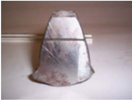
Fig. 7 Vistas de la sección de fractura de los dientes.
