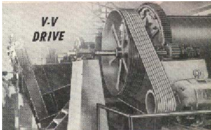
Fig. 3 Sistema de transmisión usado en los molinos de barras de F.I.T. Ltda.
