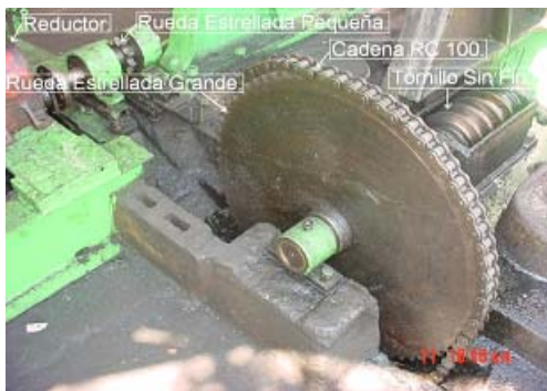
Fig. 3 Vista del reductor, la transmisión por cadena y el tornillo sin fin.
