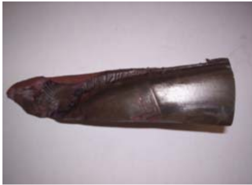
Fig. 8 Aspecto externo de las grietas de fatiga de los dientes.
