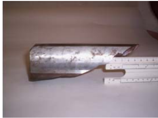
Fig. 7 Vistas de la sección de fractura de los dientes.
