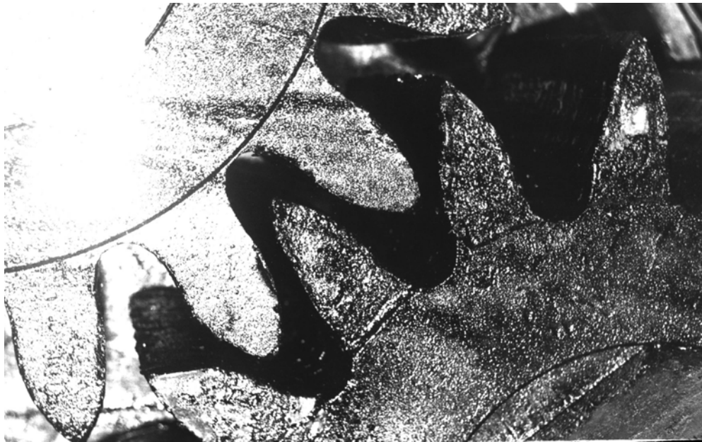
Fig. 1 Coronas engranadas en mal estado técnico de las superficies de contacto.
