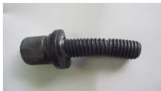
Figura. 3 Sección del tornillo fracturado y deformación plástica de la arandela. Figura 4. Deformación plástica del tornillo fracturado.
