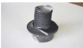
Figura. 3 Sección del tornillo fracturado y deformación plástica de la arandela. Figura 4. Deformación plástica del tornillo fracturado.
