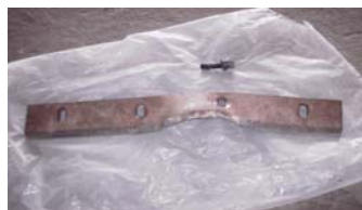
Figura 1 Vista de una Cuchilla del Molino Figura 2 Estado de la Cuchilla después de la Fractura del Tornillo.
