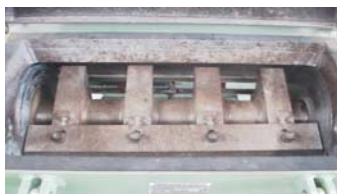
Figura 1 Vista de una Cuchilla del Molino Figura 2 Estado de la Cuchilla después de la Fractura del Tornillo.
