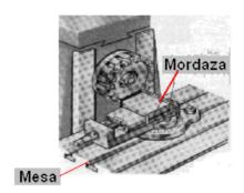
b).- Una semiproducto rectangular que se esta elaborando a través del fresado y sobre ella actúa la fuerza de la herramienta de corte (fresa).
