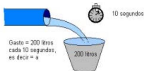
Figura 2.8: El método volumétrico para medir el gasto.
