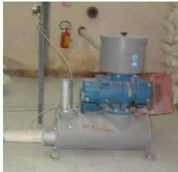
Figura 2.12 Aspirador centrífugo.
