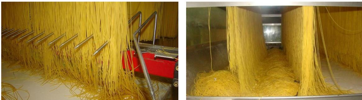
Figura 3.13 Corte de la cizalla y desperdicios generados por el mismo.
