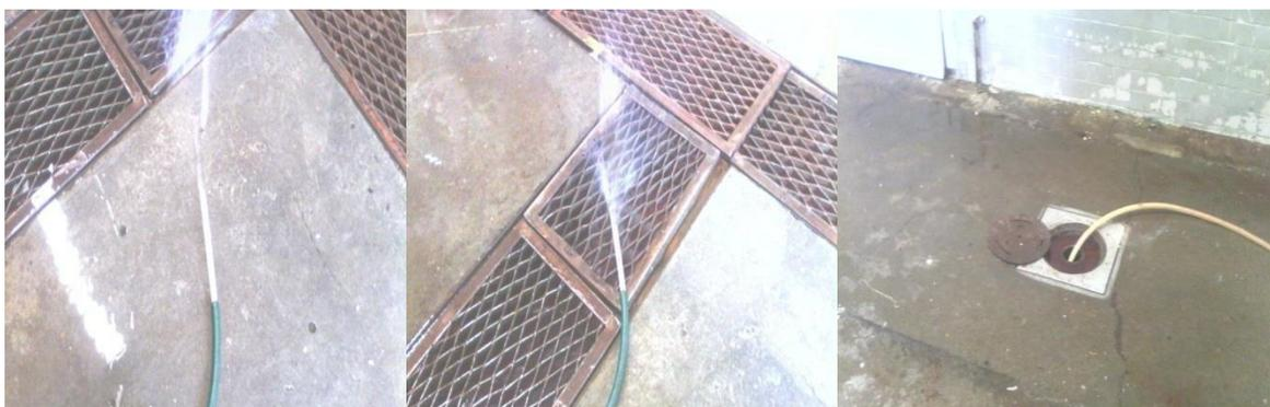
Figura 3.11 Derroche de agua en operaciones del proceso productivo.
