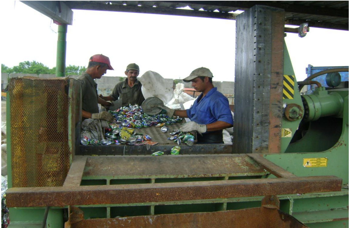
Fig. 2.15- Descontaminación manual de la chatarra aluminio.
