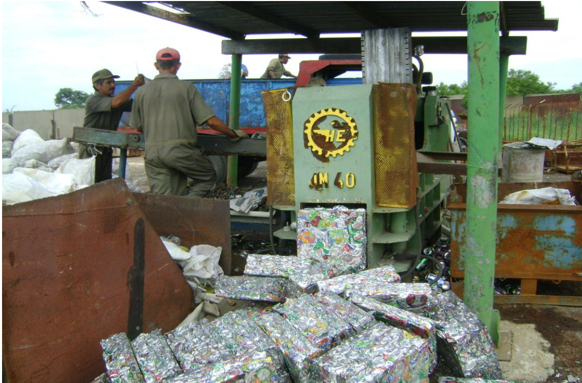
Fig. 2.16- Procesamiento de la chatarra de aluminio.
