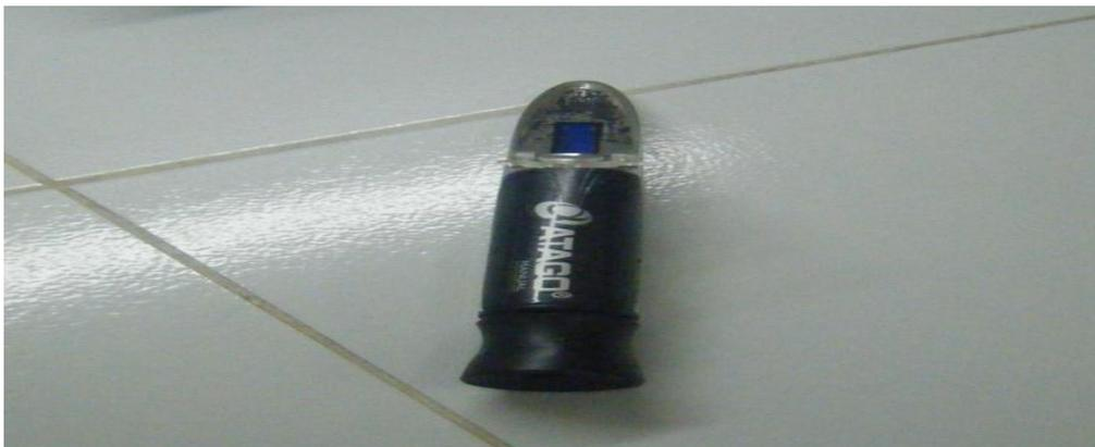
**Figura 41 Refractómetro**
