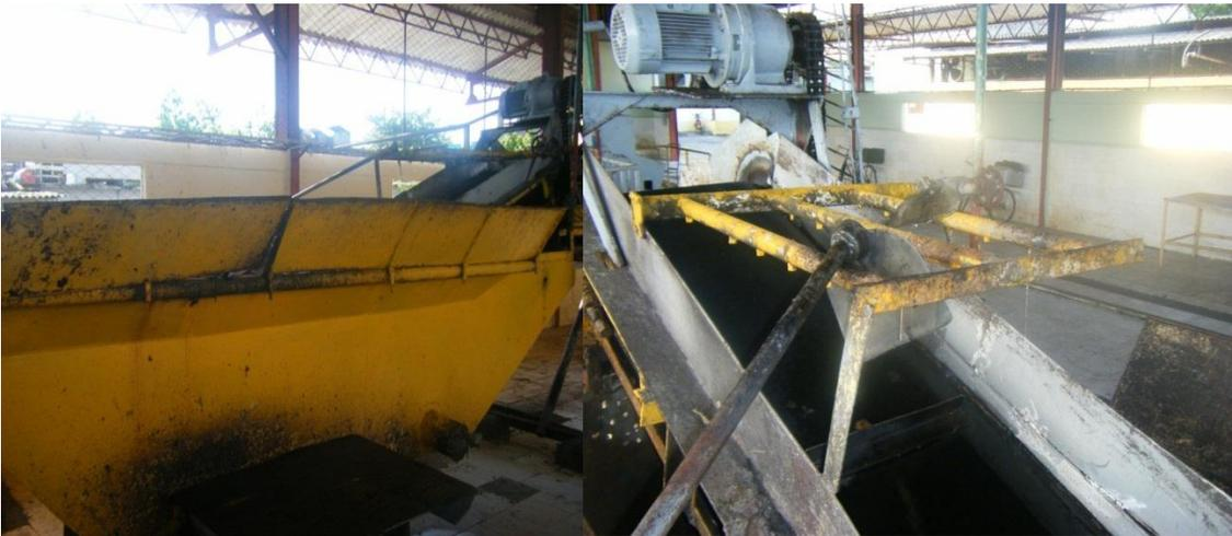
**Figura 10 Tanque de lavado.**
