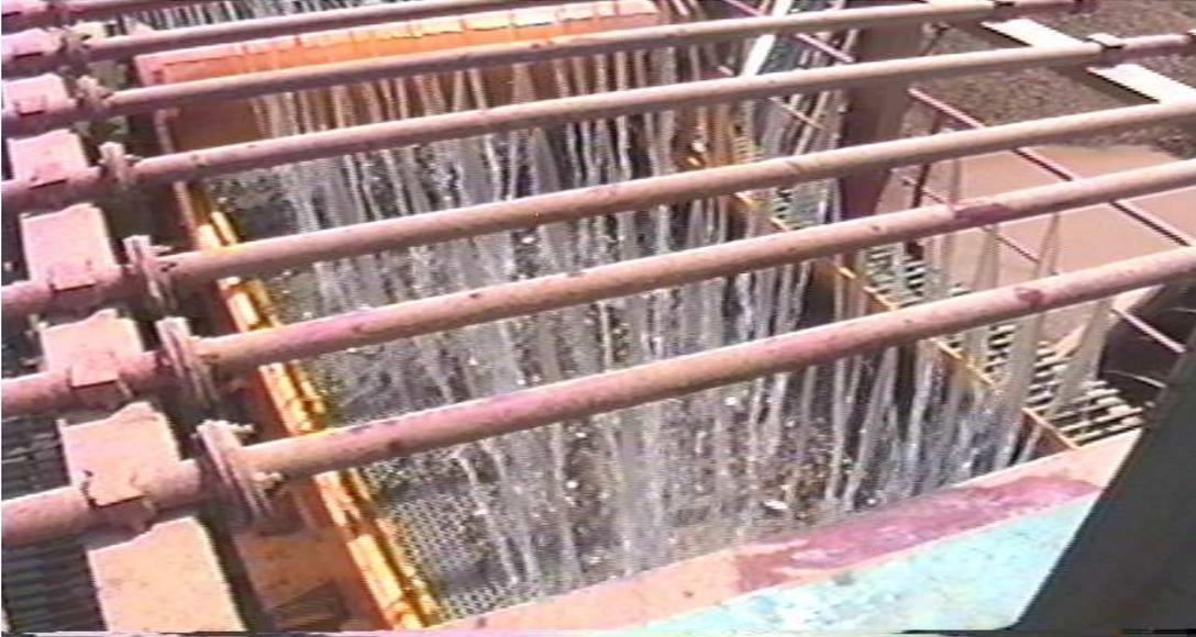
Fig. 3.5- Zaranda de lavado y clasificación preliminar.
