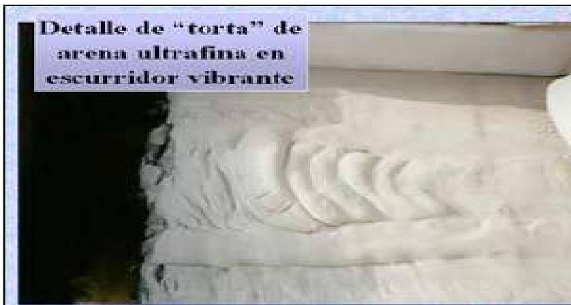
Las aguas residuales generadas en las etapas de lavado de arenas contienen sólidos en suspensión, con un tamaño máximo de partículas que en ocasiones llega hasta las **150 micras**. Las partículas con granulometrías entre **30 micras** y **150 micras**, que en adelante denominaremos: "arenas ultra finas", pueden tener un valor económico de obtenerse limpias, es decir, exentas de las fracciones más finas, arcillas y limos.
