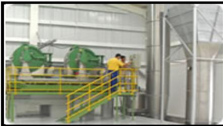
La lechada de almidón concentrada, pasa a los deshidratadores centrífugos, donde la pasta de almidón resultante, alcanza los niveles de humedad adecuados para entrar al secador final tipo flash dyers, donde las partículas de almidón alcanzan la humedad requerida para su almacenamiento y empaque.
