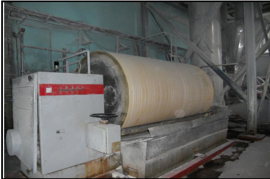
**Figura 2.8 Filtro rotatorio al vacío.**
