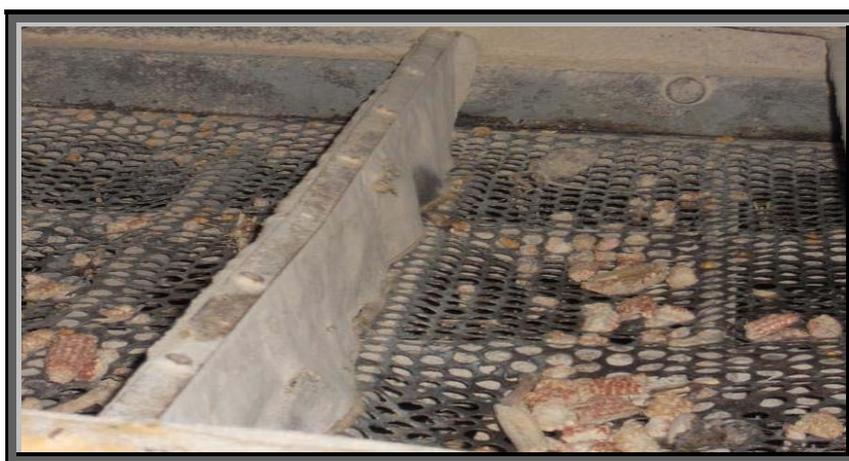
Fig. 1.10. Zaranda de tipo convencional para tamizado de maíz. Fuente: Empresa de Glucosa Cienfuegos.
