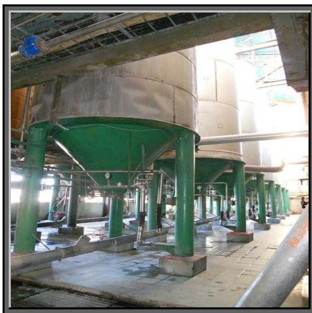
Fig. 1.12. Baterías de cubas para la maceración de maíz. Fuente: Empresa Glucosa Cienfuegos.
