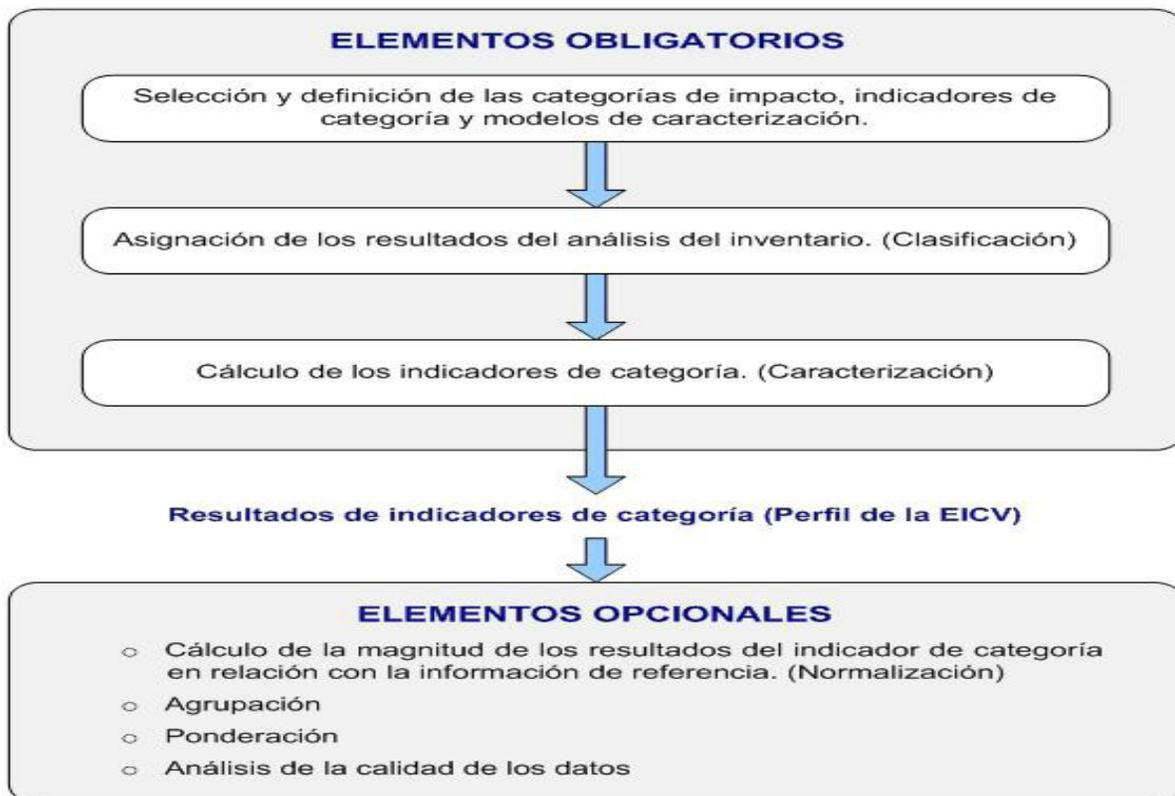
**Figura 9.** Elementos que componen la valoración del impacto del ACV. **Fuente:** (NC ISO 14 042: 2001).
