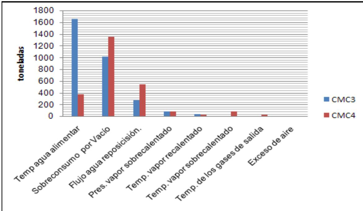
**Figura 19.** Sobreconsumos de combustibles acumulados por unidades generadoras al cierre del 2010. **Fuente:** Elaboracion Propia a partir de la base de datos del grupo de Régimen de la UEB de Produccion.
