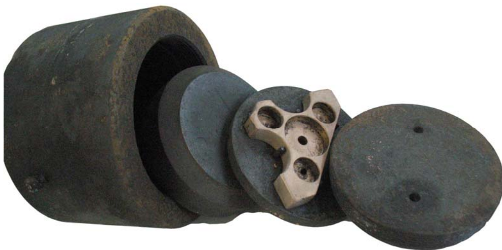
Figura 2.4 Molde para la recuperación de cojinetes planos.
