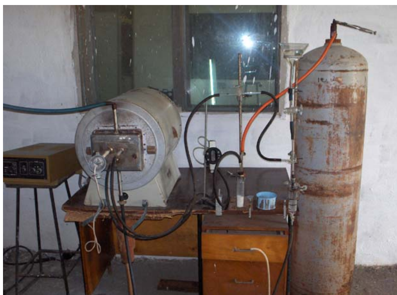
Figura 2.7. Instalación del Horno Mufla con atmósfera neutra:
