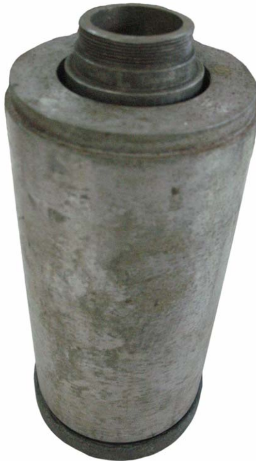
Figura 2.6. Molde de alta productividad para la fabricación de bujes del árbol de levas del tractor Komatsu.
