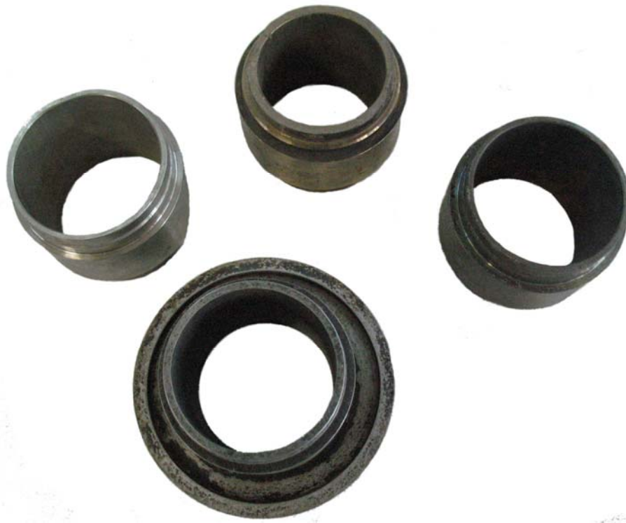
Figura 2.5. Molde para la recuperación de cojinetes cilíndricos de diferentes medidas estandarizados.
