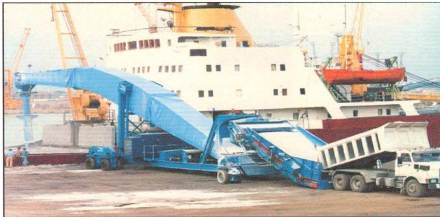
Fig. 6. Carga de graneles sucios utilizando trasbordadores portátiles de bandas al costado del buque en una terminal multipropósito.
