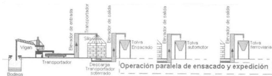
Fig.No1. Operación de descarga, recepción y entrega de graneles limpios en una terminal especializada.
