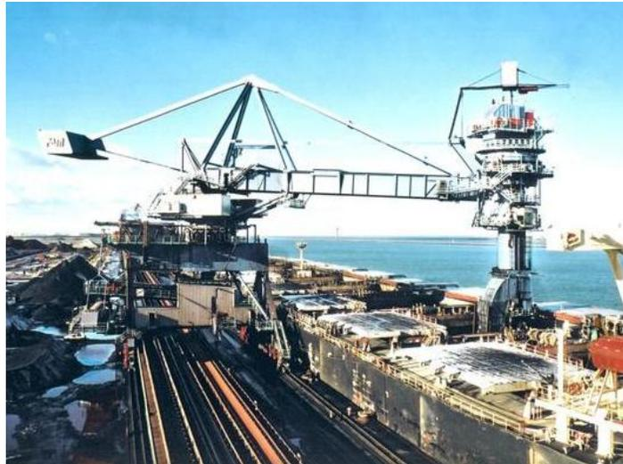
Fig. No2: Descarga de graneles sucios con equipos especializados, hacia las áreas de almacenaje a cielo abierto, en una terminal especializada.
