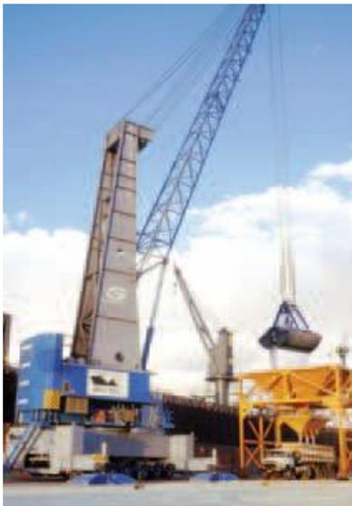
Fig. No4. Descarga de graneles limpios por variante directa con grúas de torre sobre neumáticos.
