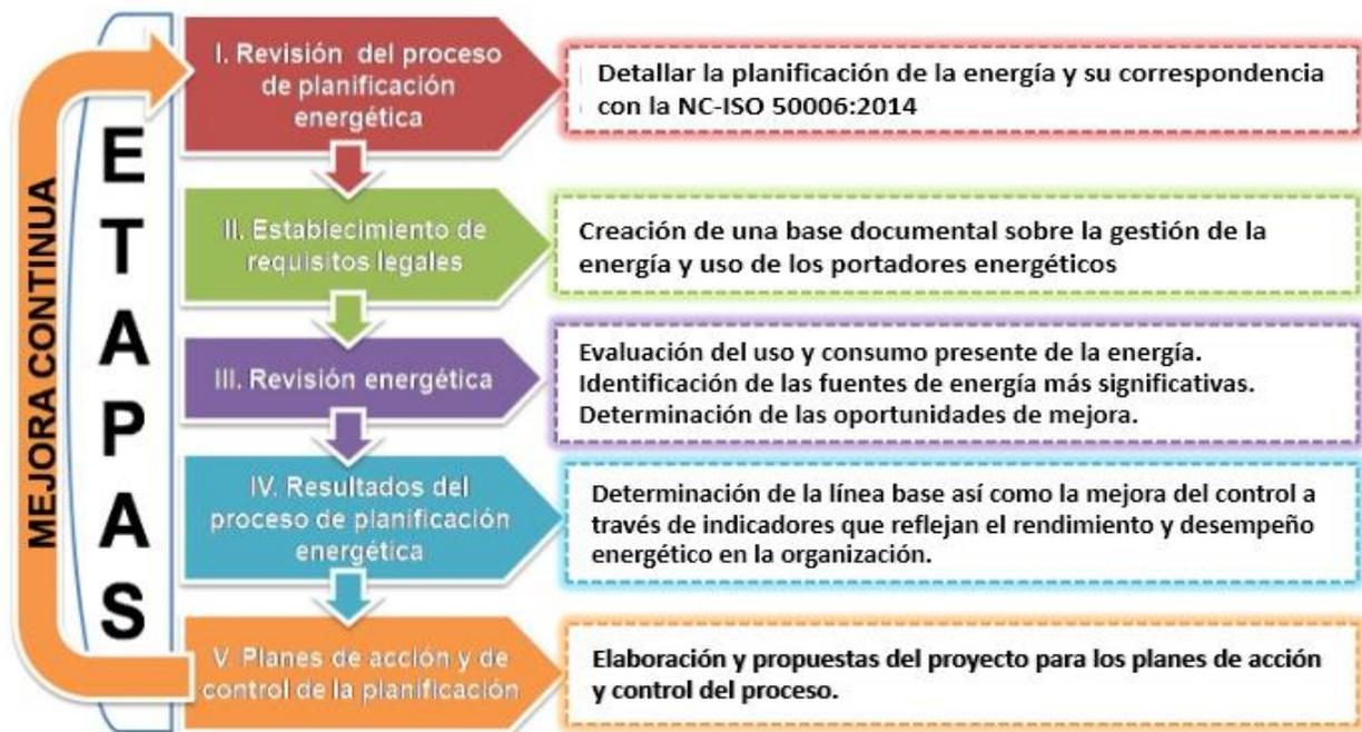
Figura 2.11: Procedimiento para la planificación energética. Fuente:(Correa & Alonso, 2017)
