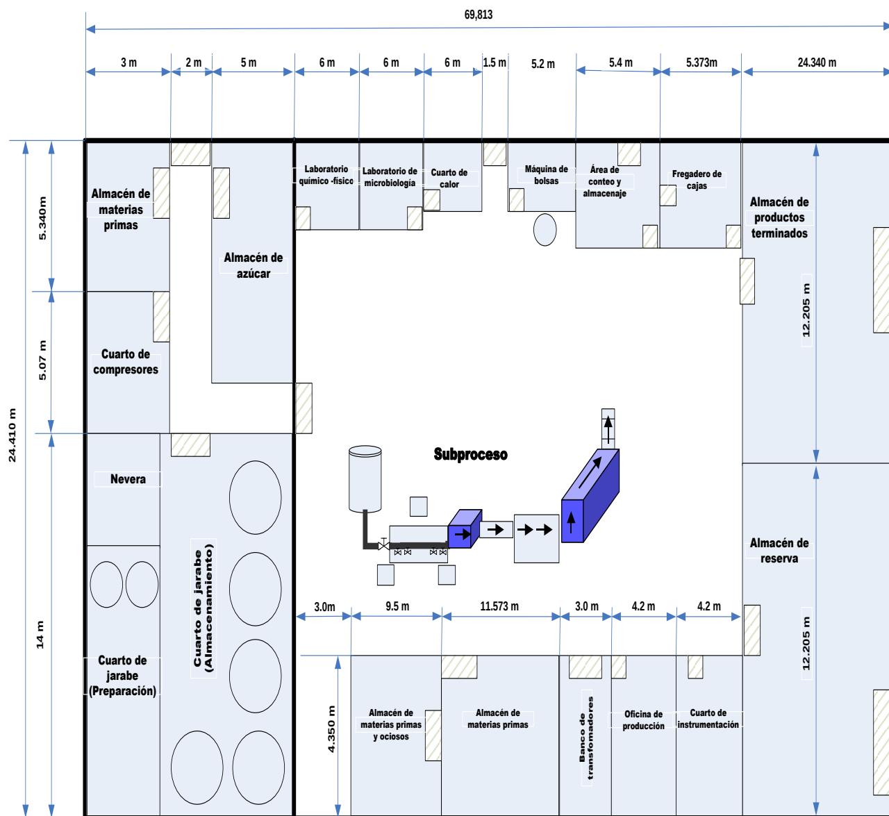
Figura 3.7: Distribución espacial del proceso de producción de refresco concentrado.
