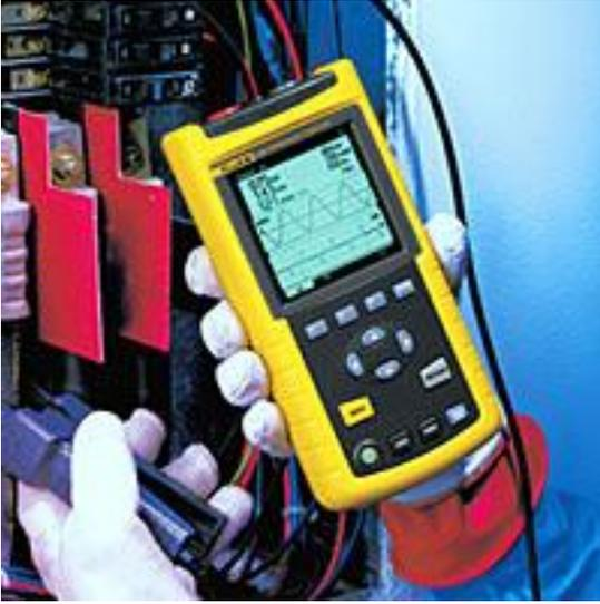
Analizador de calidad de energía Fluke 43B
