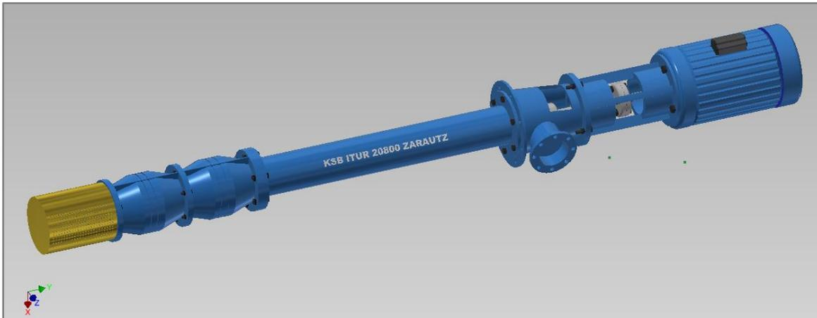
**Figura 2.4-** Vista isométrica de la bomba centrífuga KSB ITUR 20800 ZARAUTZ BEV-1226/2. Fuente: Elaboración propia
