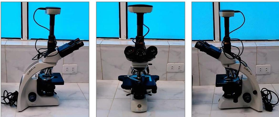
Este es un microscopio para objetivos planos corregidos al infinito 4x, 10x S40x y S-100x; con tubos portaoculares inclinados 30° y giratorio 360°.
