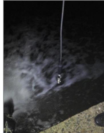
Este es un medidor digital, robusto, basado en microprocesador, con la sonda de Oxígeno Disuelto unida directamente al instrumento. El sistema despliega simultáneamente mediciones de temperatura en  $^{\circ}\text{C}$  y Oxígeno Disuelto en  $\text{mg/l}$ . La sonda puede operar en agua dulce, agua de mar o agua contaminada, en un
