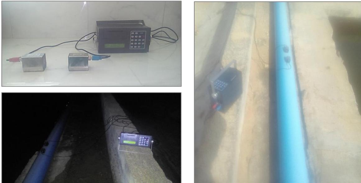
Este flujómetro está diseñado para medir la velocidad de fluidos que circulan por un conducto. Utiliza dos transductores, ambos funcionan como transmisores y receptores de ultrasonidos. Una vez configurado el flujómetro e instalados los transductores a la distancia calculada por el software del equipo, este es capaz de proporcionar la velocidad y flujo del fluido transportado.
