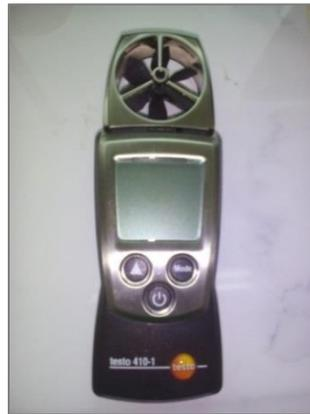
El Anemómetro de Molinete testo 410-1 modelo 05604101 mide la velocidad del viento, así como la temperatura; con rangos desde 0,4 hasta 20 m/s y -10 hasta 50 °C, respectivamente.
