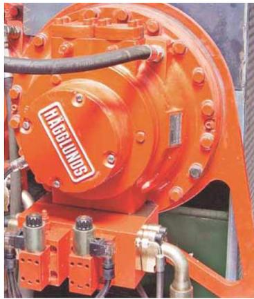
**Figura 1.5 Foto de un motor hidráulico de pistones radiales como los utilizados en el accionamiento de los molinos. (Tomado de [www.hagglunds.com](http://www.hagglunds.com))**
