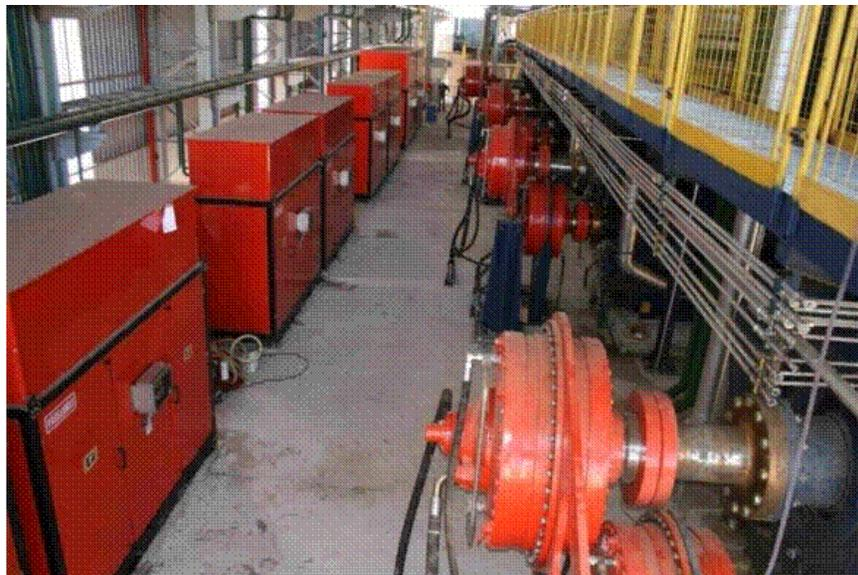
**Figura 1.6 Foto de un tren de molinos accionado por motores hidráulicos. (Tomado de (Lewinski J, Grassmann P and Kallin T; 2011).)**
