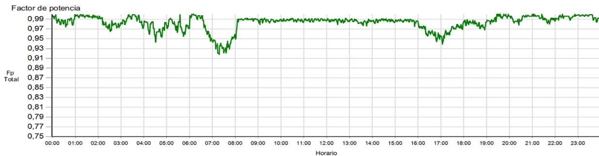
**Figura 3 - 15. Gráfico de factor de potencia total**
