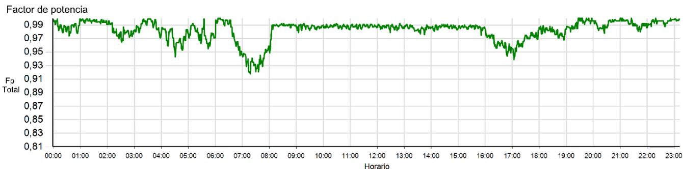
**Figura 2 - 19. Factor de potencia total en el tiempo**
