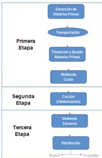
Figura 3: Diagrama del proceso productivo.
