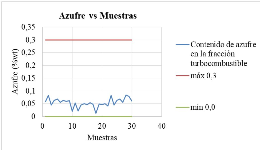
**Figura 2.8.** Análisis de control del contenido de azufre en la fracción turbocombustible.
