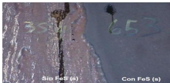
Figura 1.3. Contraste entre superficies del fondo de una regeneradora sin FeS y con FeS. Fuente. (T. D. C. Company, 2016).
