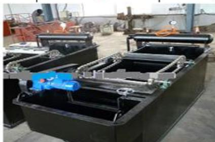
**Fig. 3.13.** Modelo de equipo de FAD. **Fuente:** (Alibaba, 2019).
