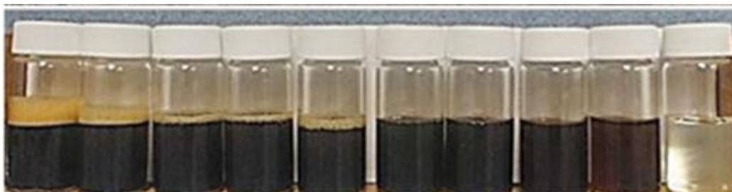
**Fig. 1.4.** Niveles de espuma a medida que aumenta la carga contaminante. **Fuente:** Elaboración propia.
