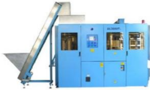
Figura 2.4: Maquina de Sopladora Automática de PET BOTTLE BLOWING MACHINE. Modelo AL – 3000, procedente de China, cavidades 3, Potencia 16 kw. Fuente: Información proporcionada por la empresa.
