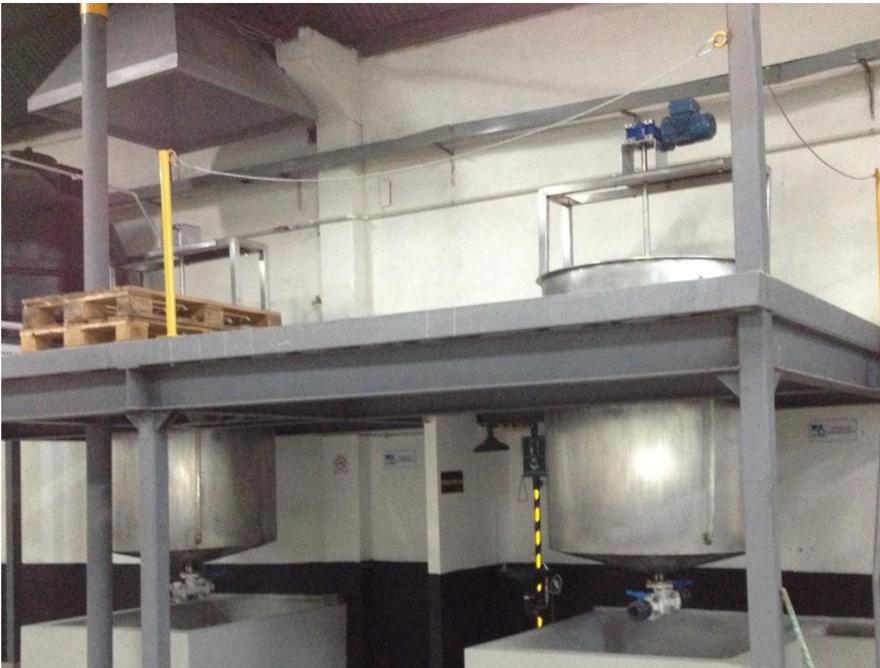
**Figura 3.3.** Campana de extracción de vapores instalada a un tanque de mezclado. **Fuente:** EQUIFA (2020)
