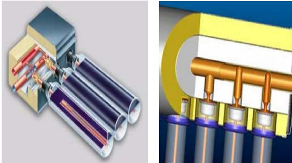
**Fig. 2.11.** Esquema de conexión de los tubos. **Fuente:** (Rodríguez- Trujillo, 2015)
