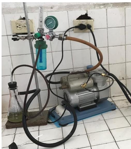
**Fig. 3.2.** Montaje del equipamiento para la aireación de la sosa gastada. **Fuente:** Elaboración propia.
