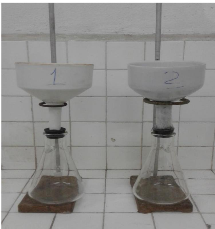
**Fig. 3.3.** Montaje del equipamiento para la filtración de la muestra oxidada. **Fuente.** Elaboración propia.
