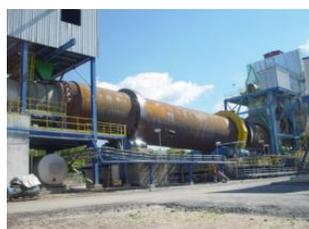
Fig. 2.2 Secador de materias primas.
