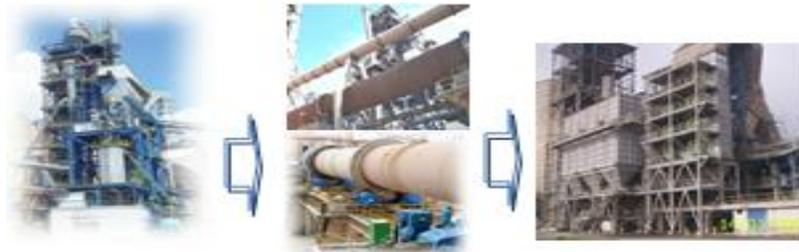
Fig. 2.5 De izquierda a derecha aparecen: precalentador, molino de petcoke hornos y enfriador de clinker.
