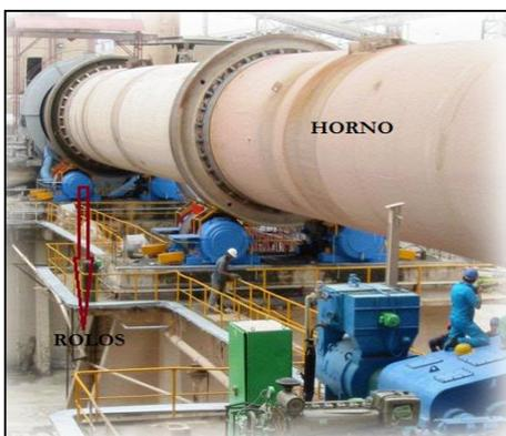
Fig. 3.6 Sistema de enfriamiento de los rolos del Horno.
