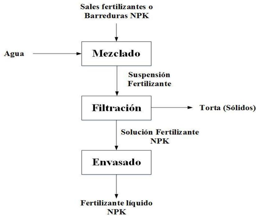
Figura 2.3. Diagrama de bloque del proceso tecnológico.
