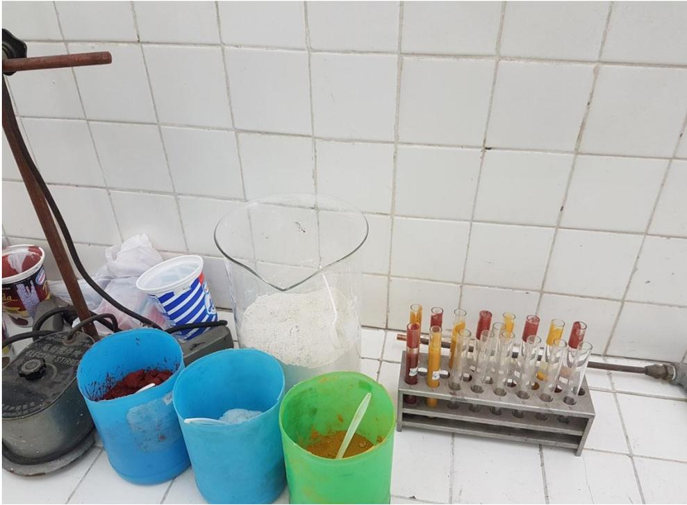
**Figura 6. Mezclas obtenidas en la producción de pintura económica.**
