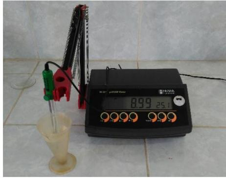
**Figura 3.1.** Equipamiento utilizado para la medición del pH. **Fuente.** Elaboración propia
