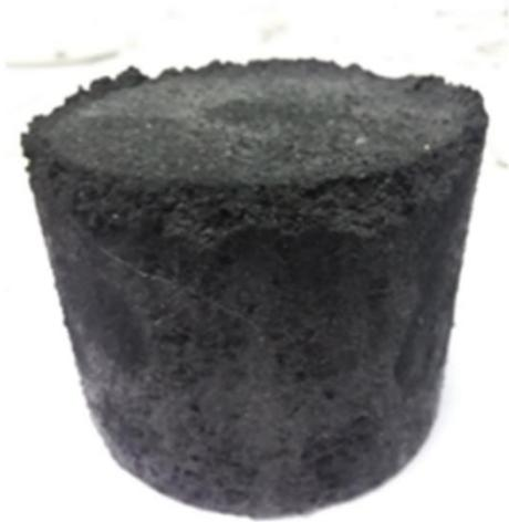
Figura 3.4. Briquetas fabricadas con presencia de moho. Fuente: Elaboración propia.
