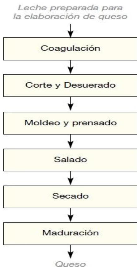
Figura.1.7. Diagrama de bloque para la fabricación del queso. Fuente. (Centro de Actividad Regional para la Producción Limpia, 2002)
