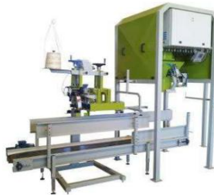
Figura 20. Sistema electro-neumático para pesado y envasado en sacos. Fuente: (Crisci, 2017).
