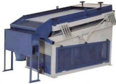
Figura 14. Separador densimétrico. Fuente: (Crisci, 2017).
