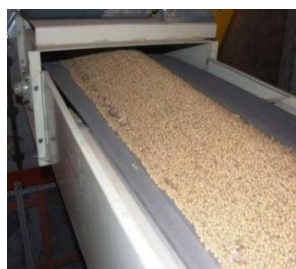
Figura 16. Transportador de banda cóncavo. Fuente: (Crisci, 2017).
