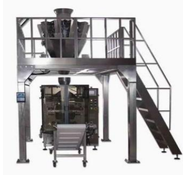
Figura 21. Envasadora para puesta en bolsas. Fuente: (Crisci, 2017).
