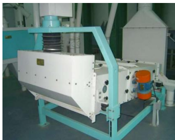
Figura 12. Separador vibrante. Fuente: (Crisci, 2017).
