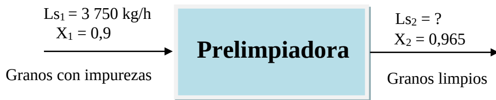
Figura 24. Diagrama de bloques de la etapa de prelimpieza. Fuente: Elaboración propia.
