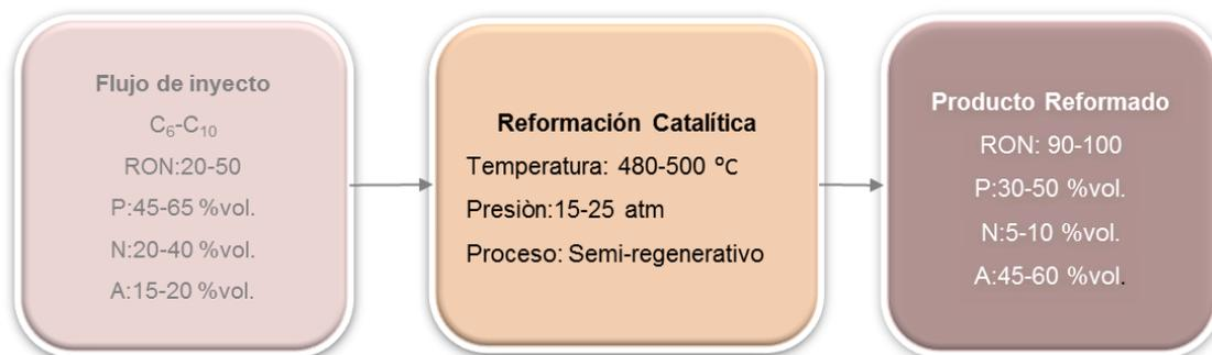
**Figura. 2.3:** Dinámica del proceso dereformación catalítica
