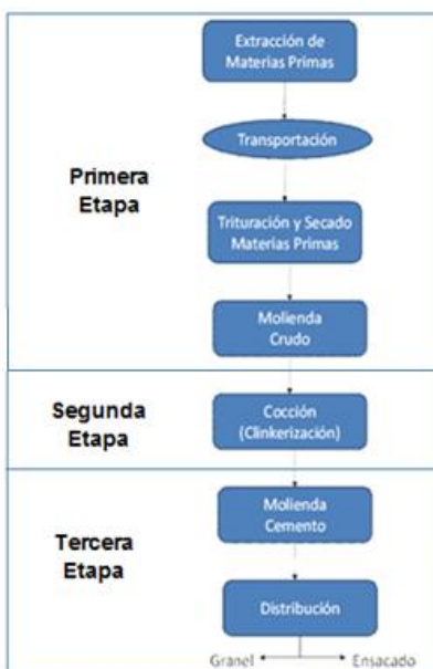
Fig. 2.1: Flujograma del proceso productivo.
