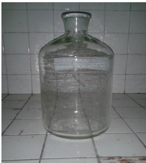
**Digestores(Fig. 2.2):** Se utilizó 2 tipos de digestores en la realización de los experimentos, uno de cristal de 5 litros donde se realizó la mezcla de los residuales industriales con el purín de cerdo, y los otros digestores de pomo plástico de 5 litros Ciego Montero con sus tapas originales en donde se depositaron las restantes muestras.
