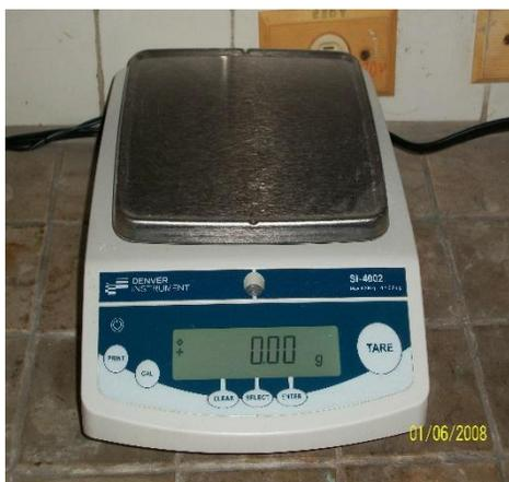
**Balanza Técnica (Fig. 2.4):** Se trabajó con una balanza de marca Denver Instrument, modelo SI-4002, con un máximo de pesaje de 4 kilogramos y un porcentaje de error igual a 0.01 gramos la cual nos permitió pesar la materia prima que se utilizaron en los experimentos y para algunos ensayos de laboratorio.
