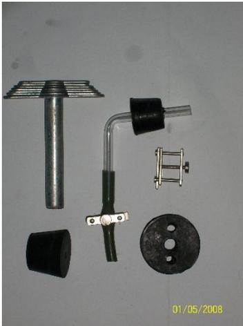
**Horador (Fig. 2.5):** Para abrirle orificios a los tapones de goma y poder introducirles los instrumentos como el termómetro y una bureta recortada.
