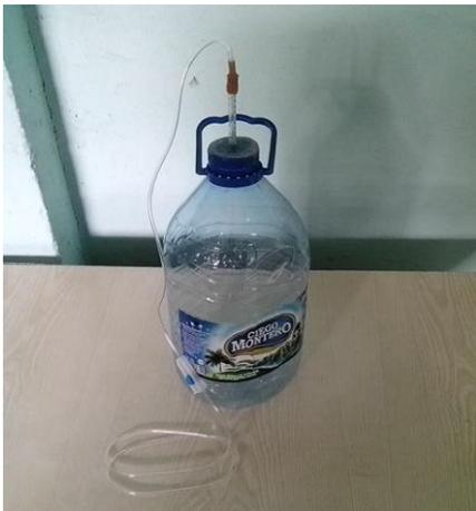
Fig. 2.7 Digestor de plástico
