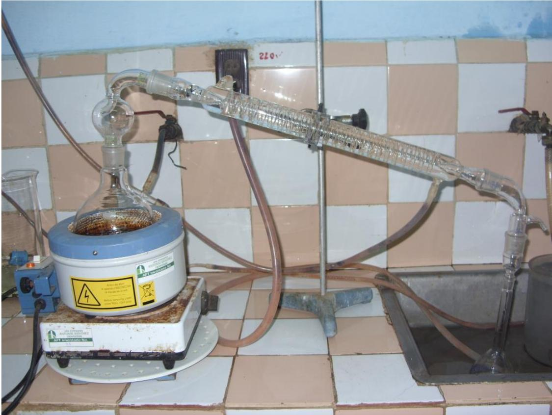
**Foto 3.1 Montaje para la destilación del vino.**
