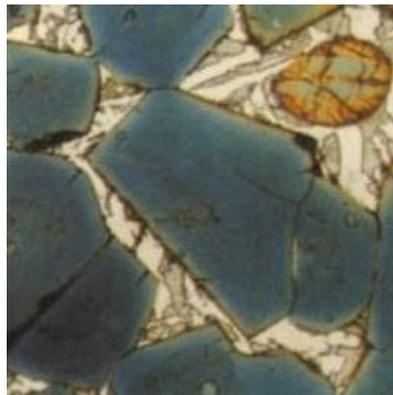
**Figura 1.13 Imagen al microscopio del cemento portland férrico.**
