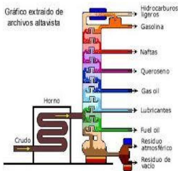
Figura 3.3. Esquema de una torre de destilación.
