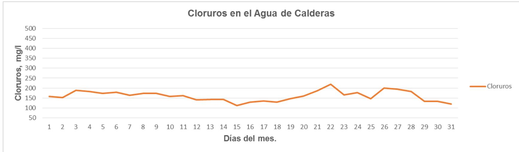
El control de que el ciclo de concentración que se mantiene en una caldera es el requerido, se realiza mediante la medición de los cloruros en el agua de alimentación y agua de la caldera. Los cloruros son utilizados como variable de control, ya que, no participan en el tratamiento de agua y son fáciles de medir.
