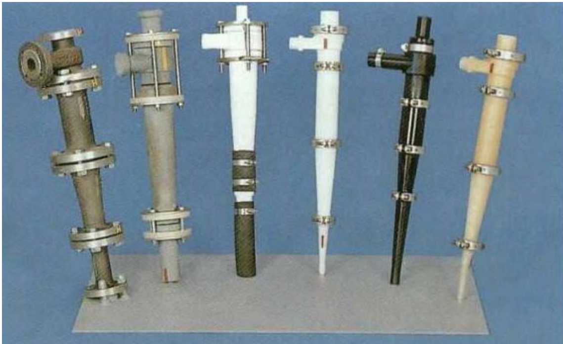
Figura 2.7 Ciclones de diferentes formas y materiales
