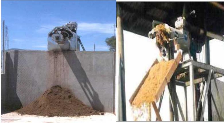
**Figura 1.7 Separador de tornillo prensa. Fuente: (Peralta, 2005).**
