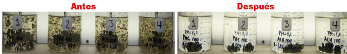
**Figura 22.** Resultados de las pruebas para seleccionar la dosis de floculante.
