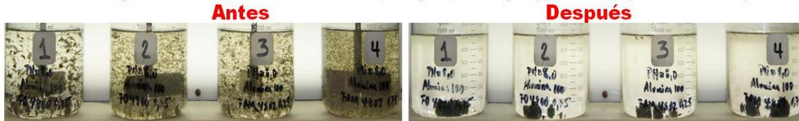
**100 mg/l (Policloruro de Aluminio, Hidroxicloruro de Aluminio)
