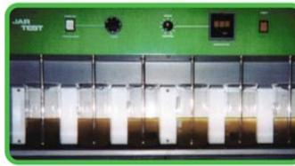
1- La inyección de los reactivos: después de preparar las diferentes soluciones de los reactivos que se van a comparar, la inyección debe ser simultánea y en dosis predeterminadas.
