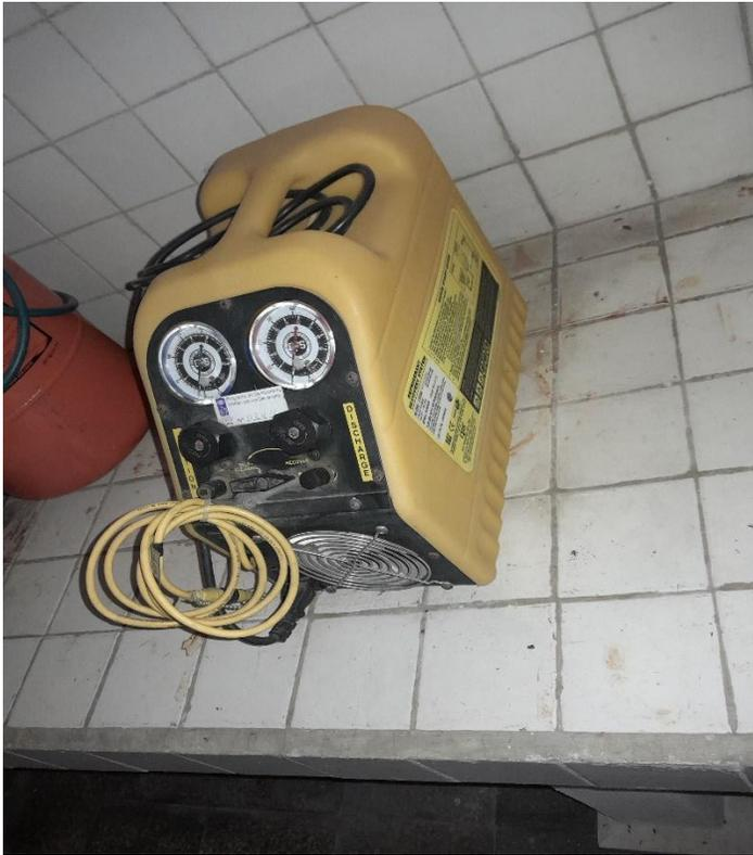
Figura 2.5 b Máquina para recuperar gas refrigerante portable de la UCF
