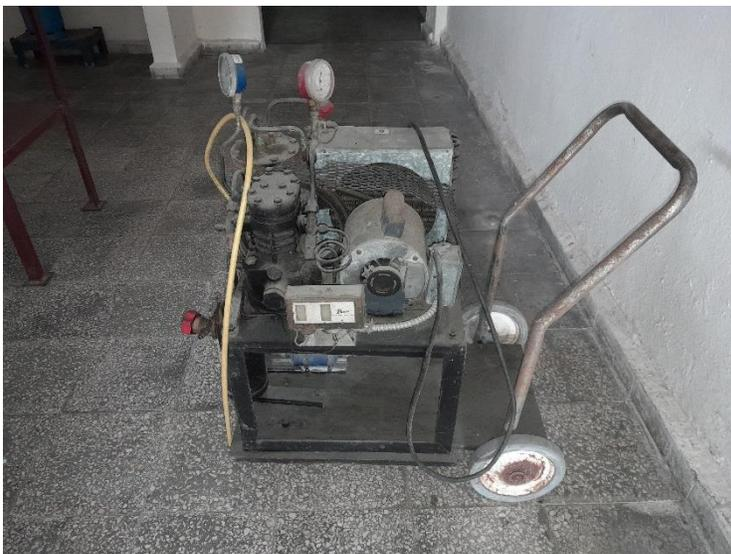
Figura 2.5 a de una Máquina para recuperar gas refrigerante móvil de la UCF
