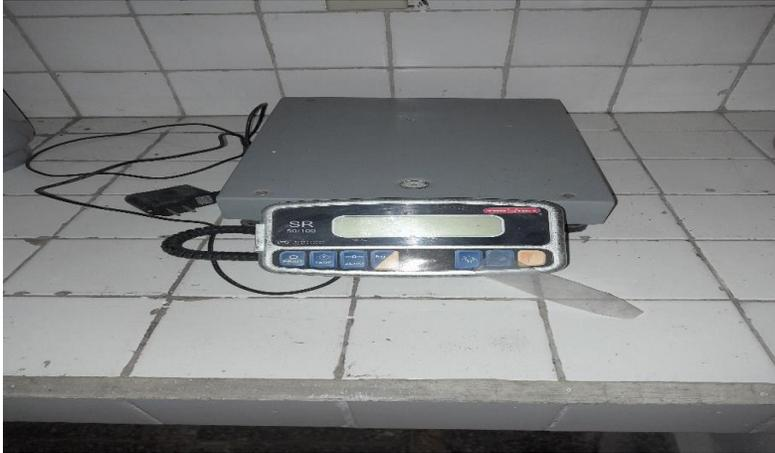
Figura 2.7 Balanza para pesaje de gas refrigerante de la UCF
