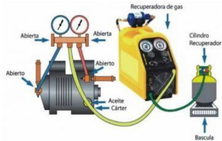
Figura 2.5 Máquina para recuperar gas refrigerante móvil de la UCF
